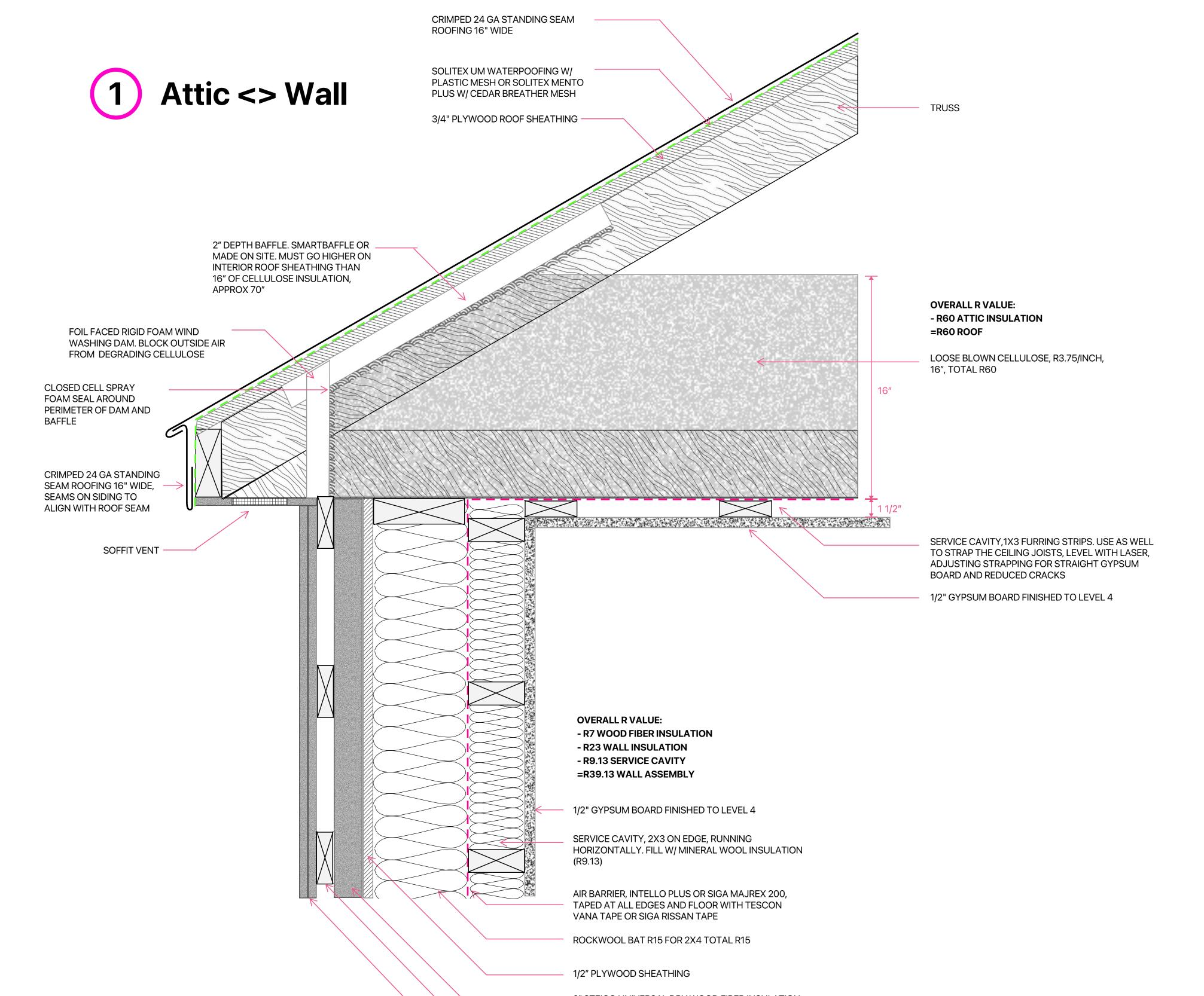
2" STEICO UNIVERSAL DRY WOOD FIBER INSULATION (R7). TAPE AND SEAL SEAMS. 1X3 PT BATTENS @16" OC RUNNING HORIZONTAL FOR RAIN SCREEN BOARD & BATTEN HEMLOCK
